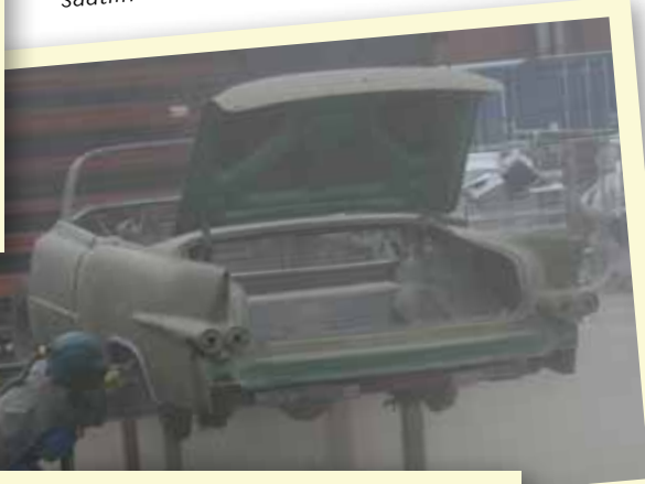
Projekti alkoi alustan hiekkapuhalluksella. Näin saatiin selkeämpi kuva projektin tilasta.
