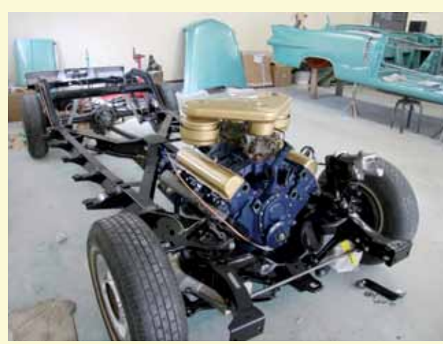
Tekniikka koottiin uusista osista ja asennettiin rungolle ennen koria. Näin oli helpompi rakennella pakoputkistot yms. tarvittavat jutut paikalleen.
